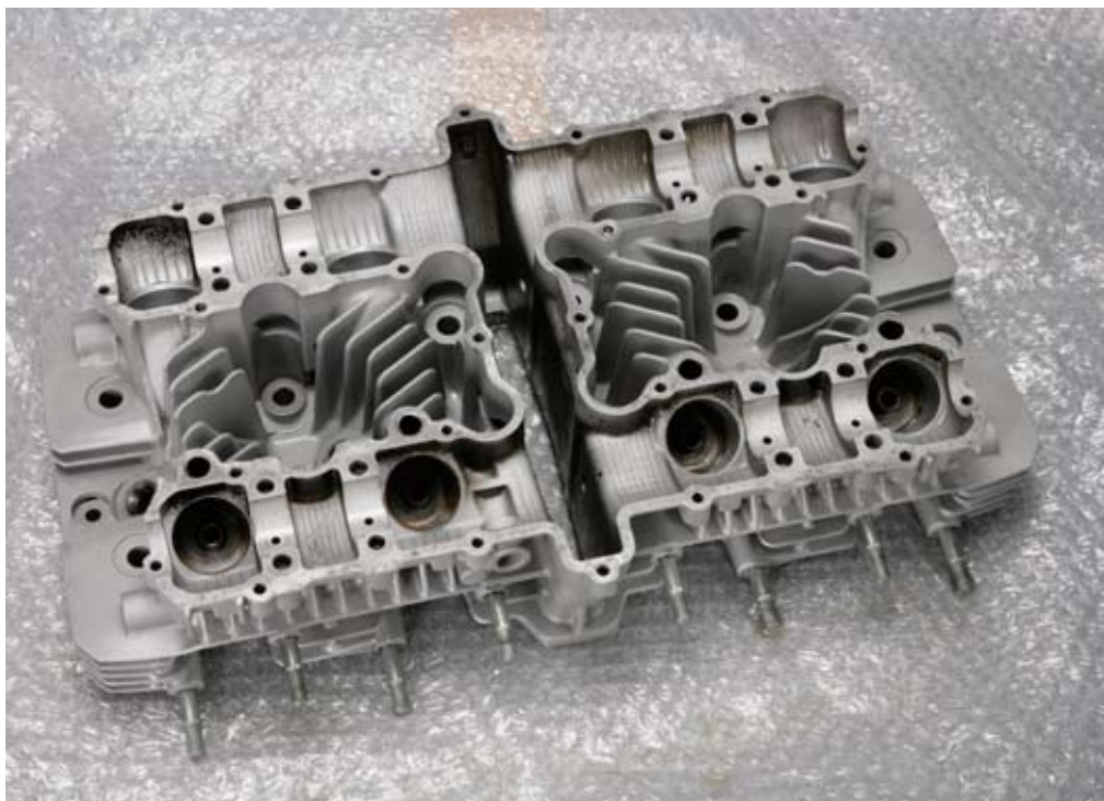
カサカサでボロボロだった黒塗装をすっかり剥離して、キレイさっぱり生まれ変わったエンジンパーツ。これらは塗装前処理のためツヤ無しのザラザラ仕上げだが、ガラスビーズで光沢仕上げにすれば美しく輝く。Z1000LTDやボリス仕様なら銀エンジンもありだ。
