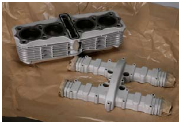
カサカサでボロボロだった黒塗装をすっかり剥離して、キレイさっぱり生まれ変わったエンジンパーツ。これらは塗装前処理のためツヤ無しのザラザラ仕上げだが、ガラスビーズで光沢仕上げにすれば美しく輝く。Z1000LTDやボリス仕様なら銀エンジンもありだ。
